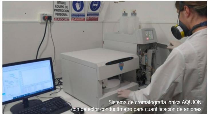
Sistema de cromatografía iónica AQUION con detector conductímetro para cuantificación de aniones
